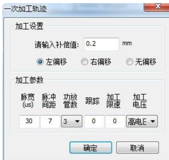
图 3-6 快走丝加工参数设置
